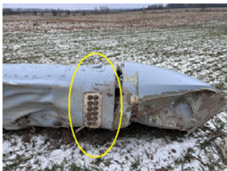
(Droits réservés) 26 janvier 2023 : cerclé en jaune, le dispositif lance-leurres L-504 a été nouvellement observé sur missile de croisière Kh-101 .
