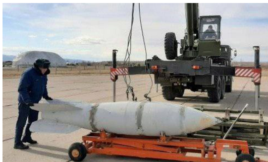
(Droits réservés) Bombe factice IAB-500 utilisée pour simuler une munition nucléaire à gravité, comme celles emportées sur bombardiers Su-24M et Su-34 .
