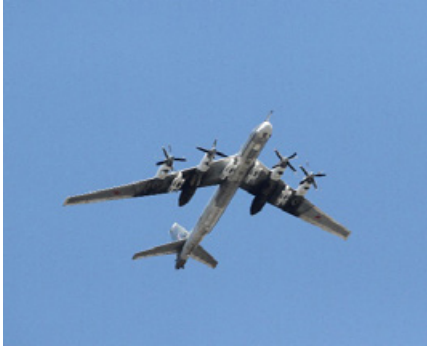
(PG) Les quatre pylônes gris clair situés sous la voilure de ce Tu-95MS signalent la capacité d'emport du missile Kh-101 .
