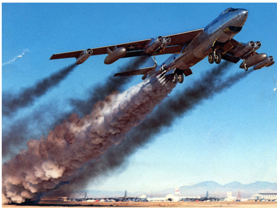
B-47 avec JATO (Jet Assisted Take-off) – 1954.
