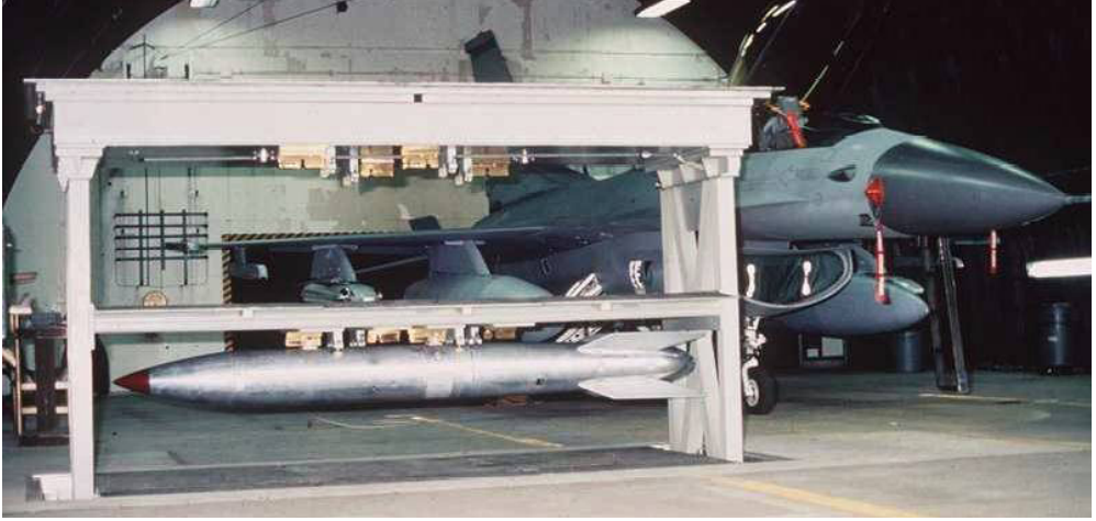
Intérieur d'un hangar durci (base aérienne de Volkel, Pays-Bas). Un WS3 contenant une B61 avec un F-16 en arrière-plan.
